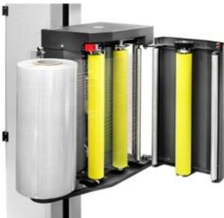
Chariot porte bobine avec système de pré-étirage motorisé avec un rapport fixe de 200% (modifiable avec le remplacement des 2 engrenages 150 et 250%). Contrôle électronique de la force sur le chariot. Système de chargement rapide du film avec protection de l'opérateur (il est conseillé d'utiliser la batterie de traction si l'on utilise ce chariot)
